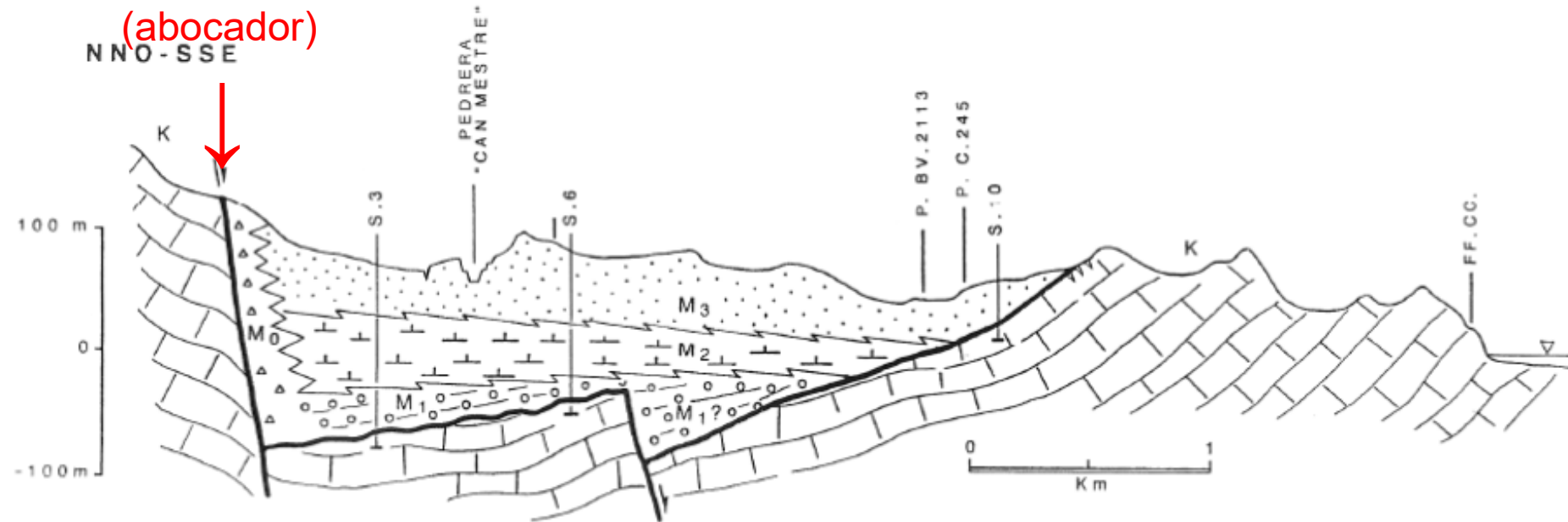
Figura 4. Tall geològic transversal de la Conca de Vilanova. Vegeu localització a la Fig. 2. Exageració vertical (x5) Redibuixat per l'autor a partir de l'original d'E. Ramos-Guerrero, A. Casas, V. Pinto i J. Agustí (1996), de la publicació Estructura y relleno sedimentario de la semifosa neógena de Vilanova (Garraf, Barcelona).
